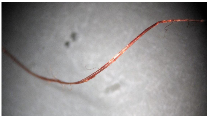
Εικόνα 26 Στερεοσκοπική παρατήρηση x 2. Ίνα κάνναβης, δείγμα από τη πίσω όψη των μαλλιών (Πηγή: Μαρία- Ιουλιάννα Αποστολοπούλου).
