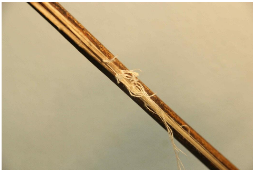
Εικόνα 20 Αποδυνάμωση των ινών στην περιοχή του δοξαριού (Πηγή: Μαρία- Ιουλιάννα Αποστολοπούλου).
